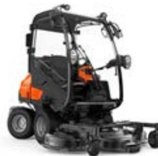
Die geräumige, vibrations- und geräuscharme Kabine mit Glastüren, Panoramafenstern und einem Grammar Sitz überzeugt mit Komfort zu jeder Jahreszeit. Ausgerüstet mit Scheinwerferlicht, Gegengewicht, Heizung, Signallampe etc.. Die Kabine kann einfach vom Chassis demontiert werden, wenn sie z.B. im Sommer nicht benötigt wird. Überrollbügel (ROPS) integriert.
